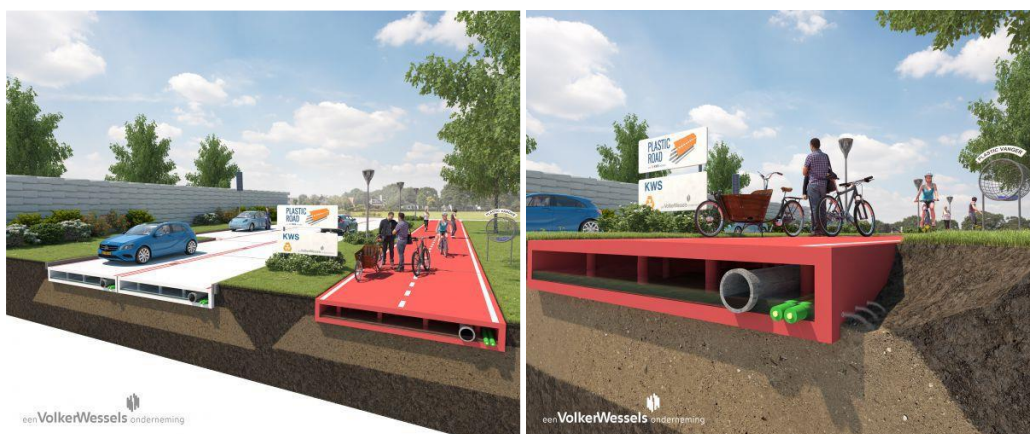
Rysunek nr 19, Grafika przedstawiająca moduły i przekrój drogi z plastiku, źródło: http://en.volkerwessels.com/en/projects/detail/plasticroad
